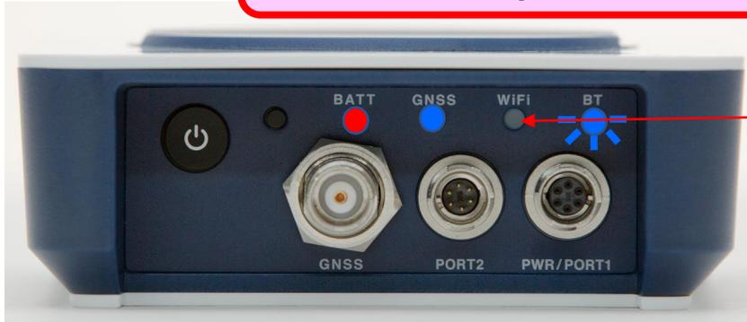
基準局で『Komatsu Ntrip Caster』を使用している時に、GNSS受信機のWiFiランプが消灯している場合は、使用しているGNSS受信機から補正データの配信が行われていません。
