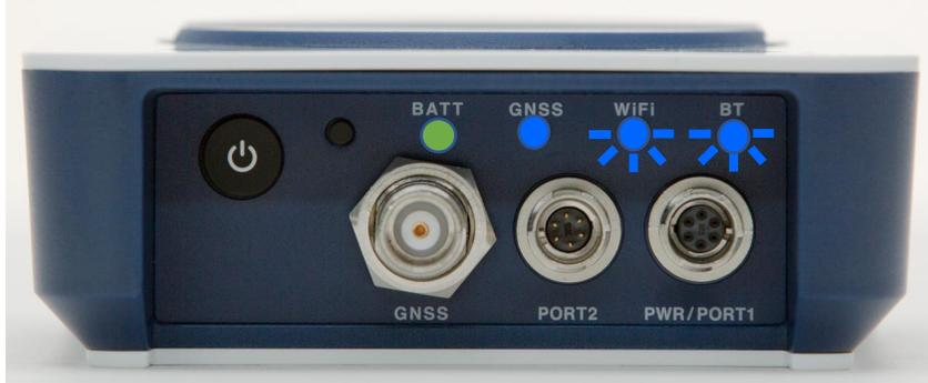
電源を『ON』して、全LED（GNSS・WiFi・BT）が点灯したまま（約1分）になって、電源が自動的に『OFF』になった場合、『SC Rover 2』のファームウェアが自動アップデートされた可能性があります。
