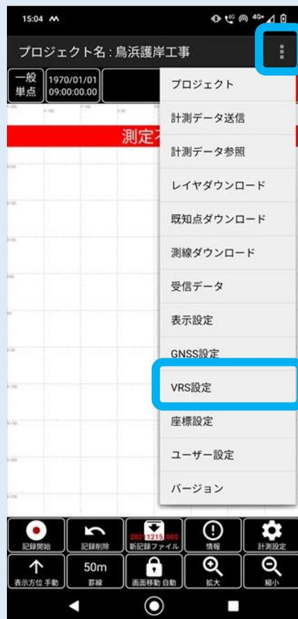
移動局の『Ntrip』への接続設定は、『SmartMate』の設定で行います。
