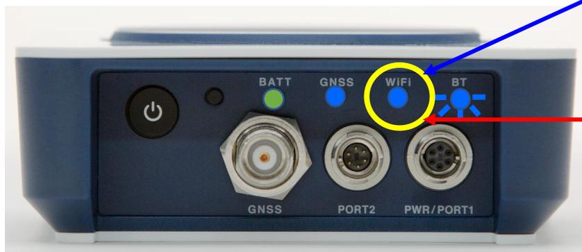
WiFiが”点灯”していればNtrip Caster Serverに接続されて、補正データを送信しています。
